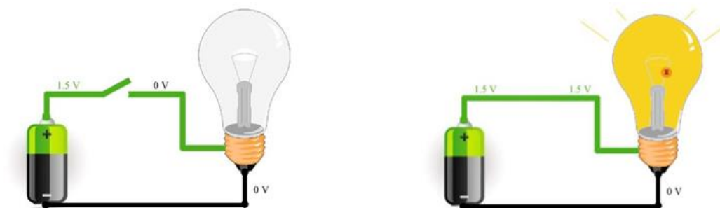
Рис. 3.9. Замкнутий електричний ланцюг
