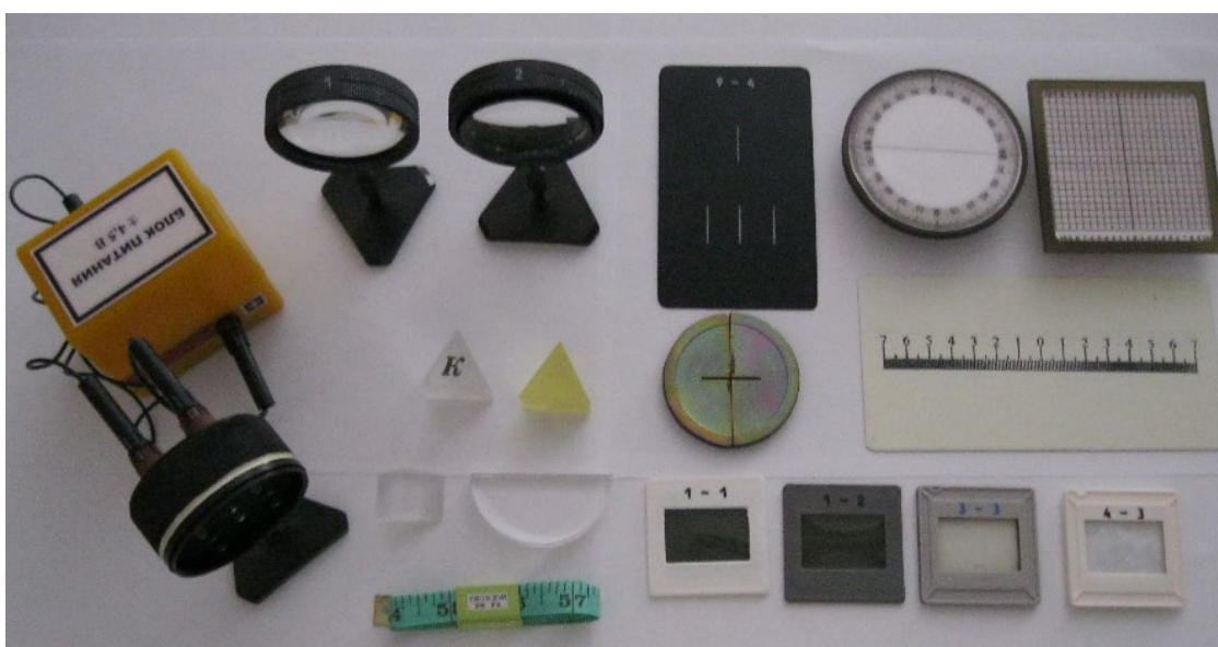
Рис. В1. Комплект для вивчення геометричної оптики
