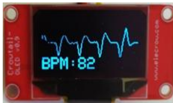
Рис. 3.14. Відображення серцевого ритму на OLED дисплеї
