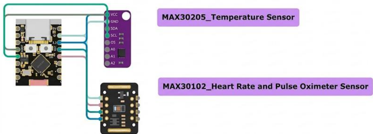
Рис. 2.23. Схема підключення датчика MAX30205 до ESP32-WROOM-32
