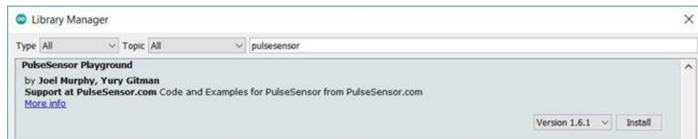
Рис. 3.6. Встановлення зовнішньої бібліотеки PulseSensor у Arduino IDE
