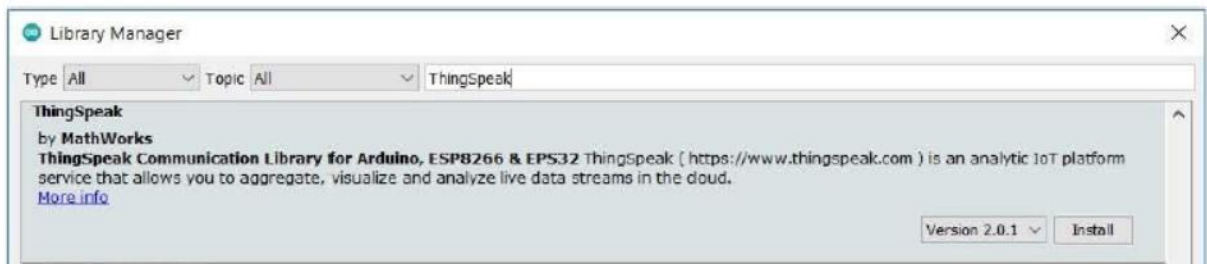
Рис. 3.22. Встановлення бібліотеки для роботи з платформою ThingSpeak
