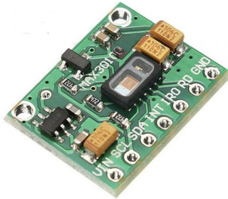
Рис. 2.8. Зовнішній вигляд давача для вимірювання сатурації та пульсу MAX30102
