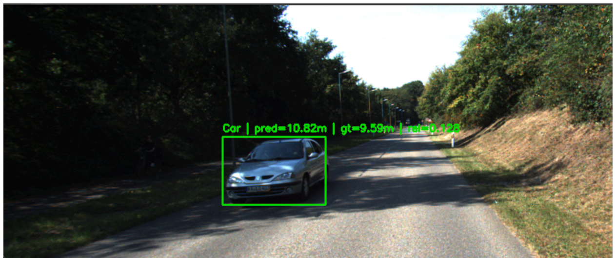
Рисунок 3.3. Геометрична оцінка відстані до автомобіля
