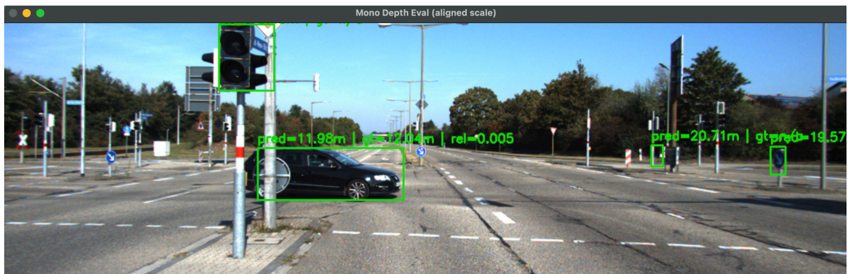
Рисунок 3.8. Зображення з камери з накладанням оцінок відстані за допомогою MDE
