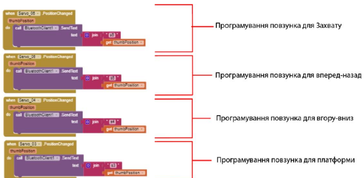
Рис. 3.28. Схема роботи повзунків для керування сервоприводами
