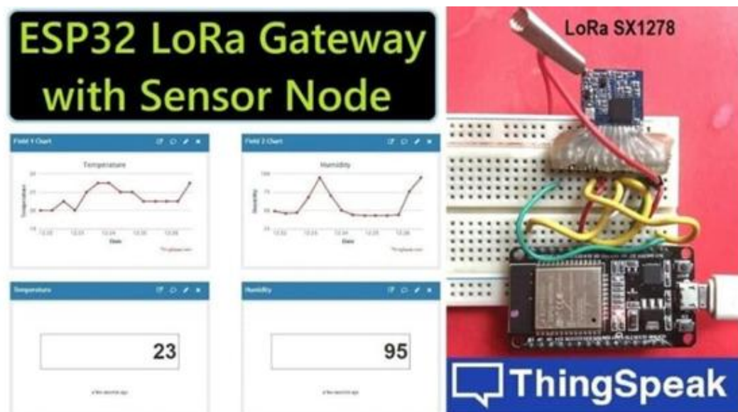
Рис. 2.18. Шлюз та вузол LoRa на ESP32 для передачі показань датчика на Thingspeak
