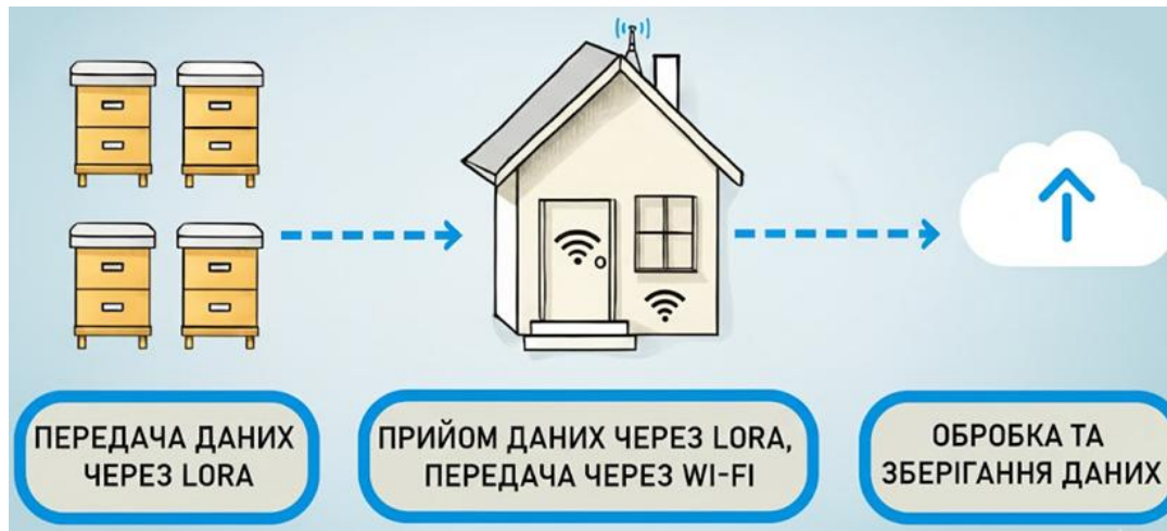
Рис. 2.20. Схема передавання даних із використанням технології LoRa
