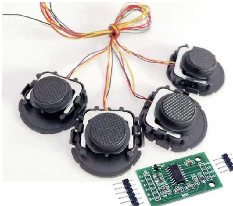
Рис. 2.8. Тензометричний підсилювач HX711 з тензодатчиками
