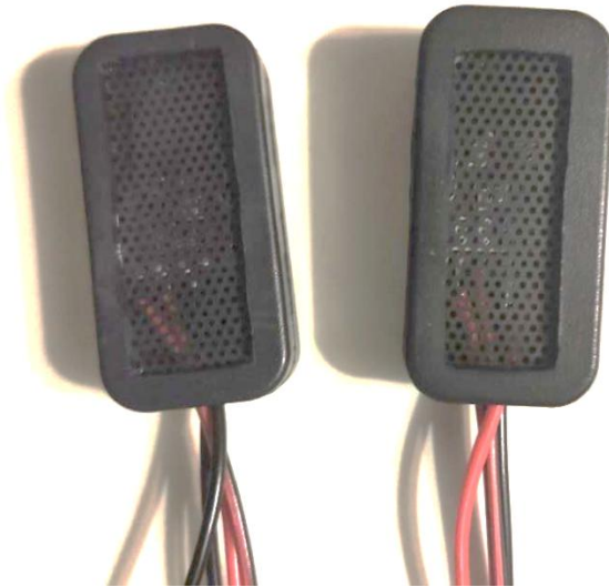
Рис. 3.9. Датчики температури та вологості в захисному корпусі з вентиляційною сіткою
