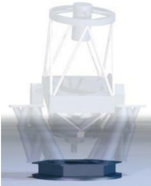
Рис. 3.2 3D-модель конструкції пірсу та основи телескопу
